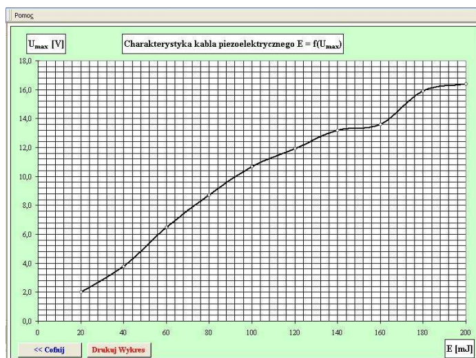
Rys. 9 Przykładowa charakterystyka U_{max}=f(E)
